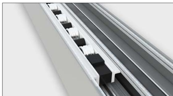
Ogni ante prevede due carrelli. Ogni carrello è composto da 4 ruote in acciaio inox resistenti alla corrosione, che scorrono su un doppio binario per ante fino a 500 kg senza alcuno sforzo di manovra. Il carrello con 8 ruote ha portata fino a 1.200 kg. Si consiglia di motorizzare ante con peso superiore a 500 kg.
